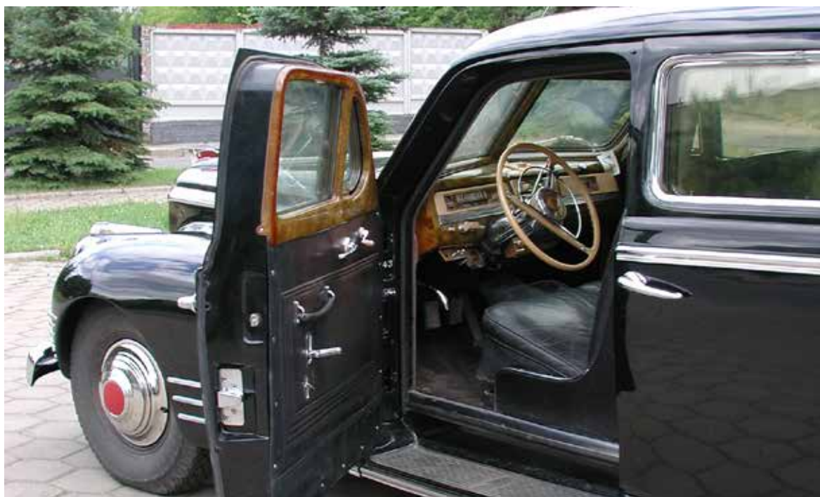
Весь интерьер бронированного ЗИС-115 подчинен функциям безопасности и удобства
