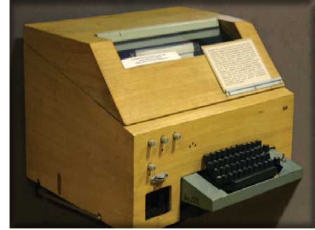
Рулонный буквопечатающий аппарат Т-63 «горячей линии» Москва—Вашингтон. 1960-е гг.
